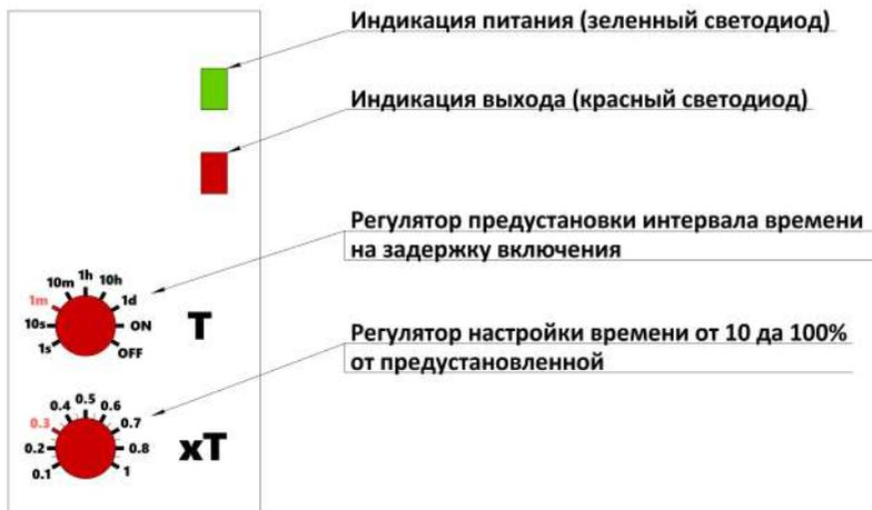
Рисунок 20. Лицевая панель реле времени.
